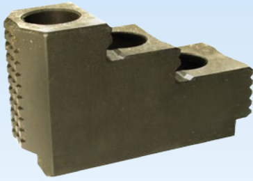
Kovat pääileukasarjat, hammastus 1,5 mm x 60 astetta (Kitawaga, Howa, Matsumoto, Strong)
